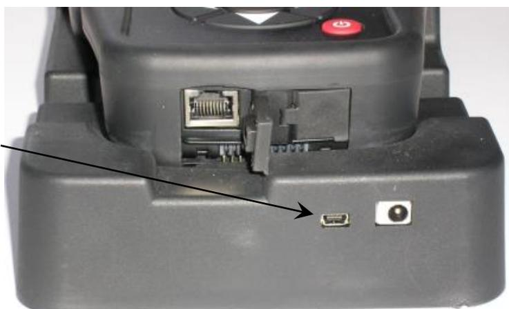
Connettore USB per l'aggiornamento tramite connessione Internet mediante alloggiamento di espansione
