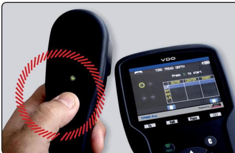
Quando tutte le ruote sono state misurate, vengono visualizzate le misure di tutti gli spessori.
