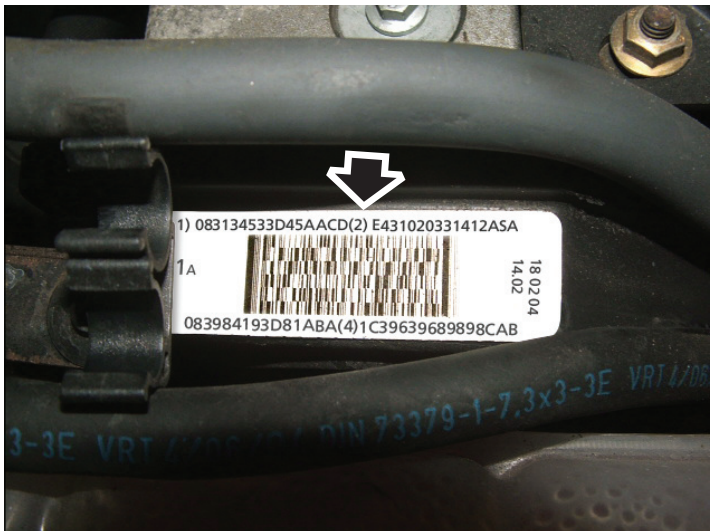
Štítek vstříkovacího ventilu - uvádí čtyři 16místná čísla
