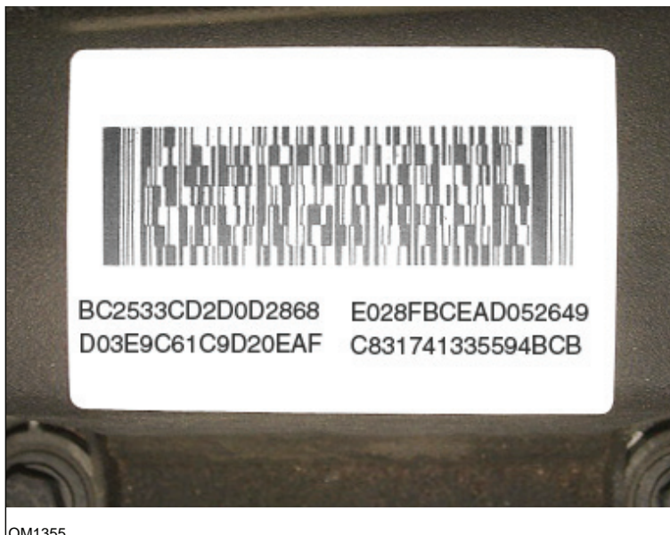
Eticheta injectorului - are patru numere de 16 cifre
