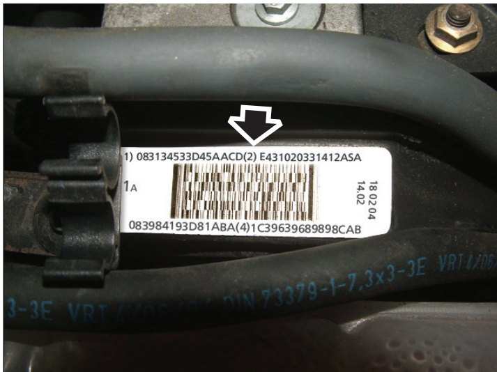
Ярлык инжектора - содержит четыре номера из 16 символов
