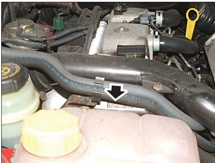
Moteur 1,8 TDCi - Étiquette de l'injecteur indiquée par une flèche sur l'illustration - Vue latérale
