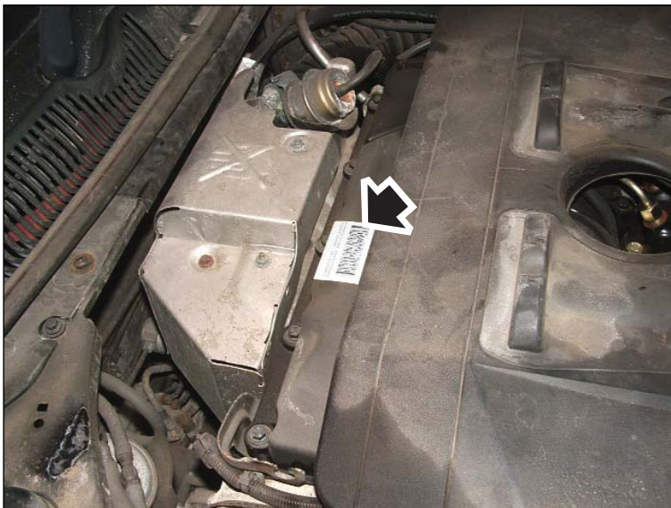
Moteur 2,0 TDCi - Étiquette de l'injecteur indiquée par une flèche sur l'illustration - Vue latérale
