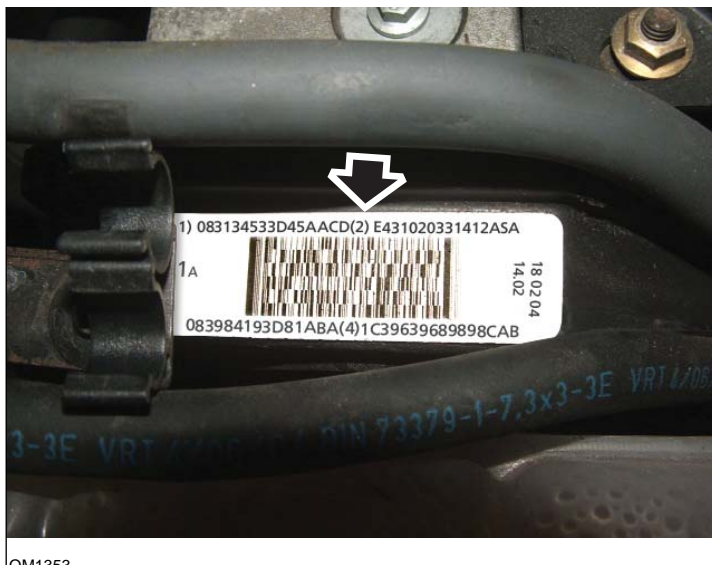
Etiquette de l'injecteur - présente quatre numéros à 15 chiffres
