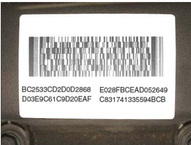
Étiquette de l'injecteur - présente quatre numéros à 15 chiffres
