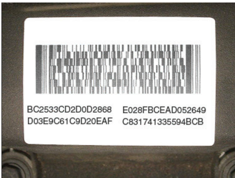
Štítek vstřikovacího ventilu - uvádí čtyři 16místná čísla
