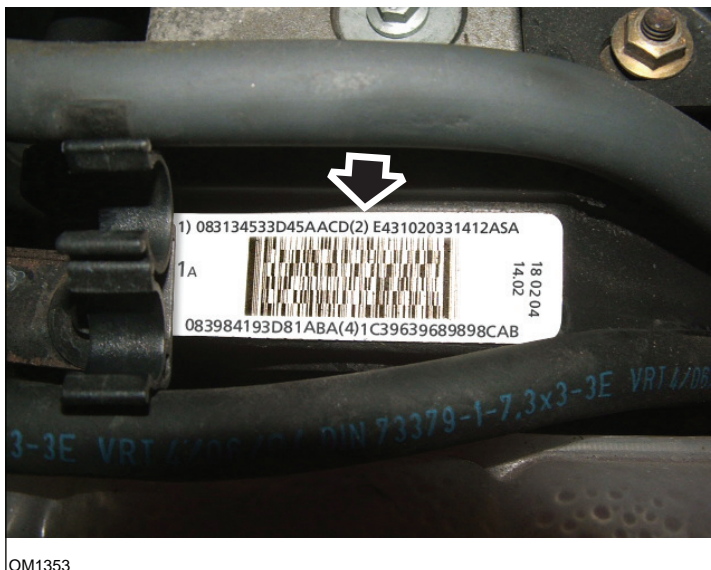
Štítek vstříkovacího ventilu - uvádí čtyři 16místná čísla
