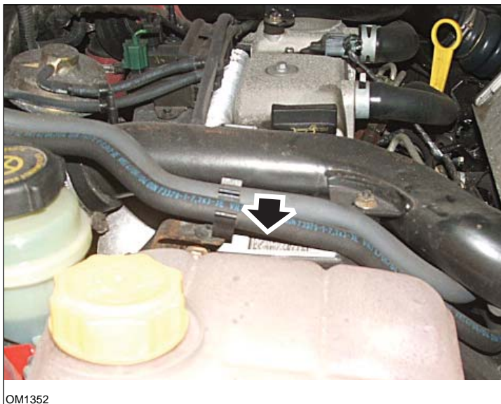
Silniki 1.8 TDCi: – Zdjęcie pokazuje naklejkę z kodami wtryskiwaczy – widok z boku.
