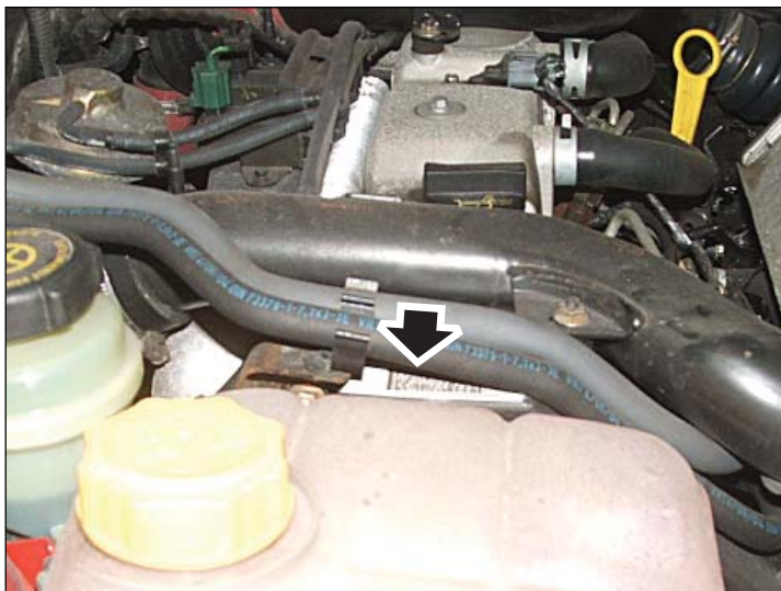
Motoare 1.8 TDCi: - Eticheta injectoarelor indicată de o săgeată în imagine - imagine din lateral
