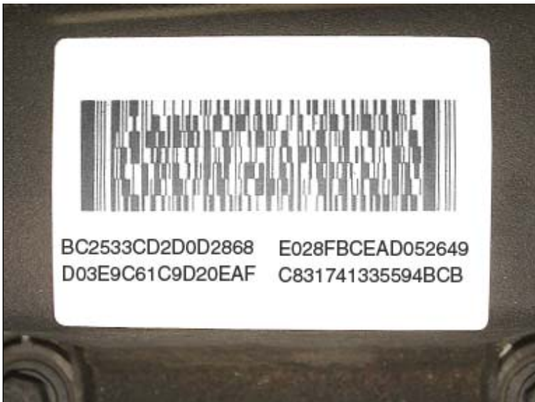
Eticheta injectorului - are patru numere de 16 cifre
