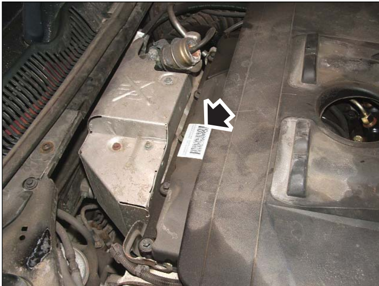
Motoare 2.0 TDCi: - Eticheta injectoarelor indicată de o săgeată în imagine - imagine din lateral
