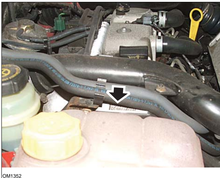
Двигатели 1.8 TDCi: - ярлык инжектора, отмеченный стрелкой на изображении - вид сбоку
