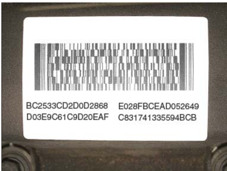
Двигатели 2.0 TDCi: - ярлык инжектора, отмеченный стрелкой на изображении - вид сбоку
