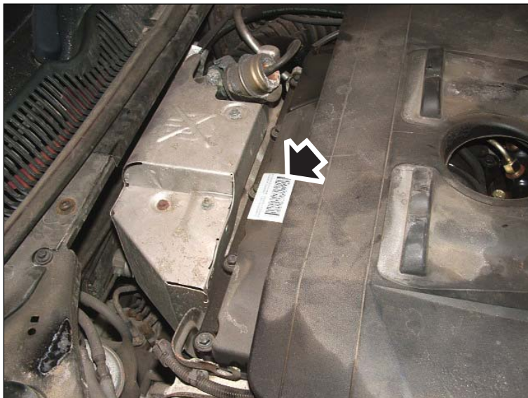
Двигатели 2.0 TDCi: - ярлык инжектора, отмеченный стрелкой на изображении - вид сбоку
