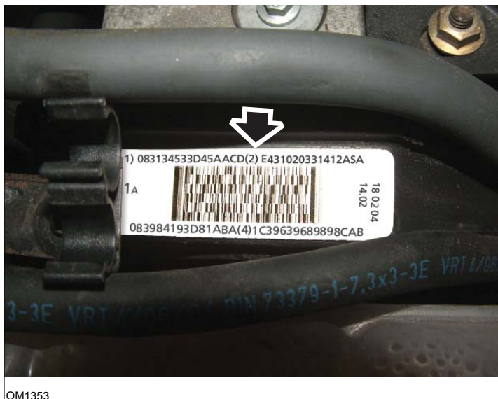
Ярлык инжектора - содержит четыре номера из 16 символов
