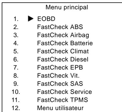
Utiliser les touches ▲ et ▼ pour sélectionner la fonction 'FastCheck Climat' et appuyez sur ✓ pour confirmer la sélection. Pour retourner au menu précédent, appuyez sur la touche ✕.
