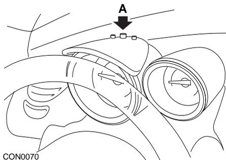
1. Mettez le contact d'allumage sur ON, puis, dans les 4 secondes qui suivent, sélectionnez l'écran d'intervalle d'entretien en appuyant sur le bouton **A** situé en haut du combiné d'instruments. (Appuyez de manière répétée, jusqu'à l'affichage de l'intervalle d'entretien.)
