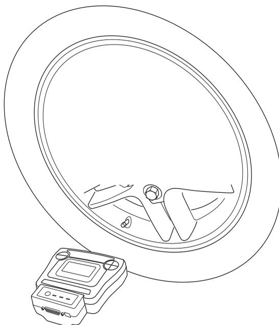
Le module TPMS essaiera de communiquer avec la soupape ; cette procédure peut prendre jusqu'à 90 secondes. Si la procédure est fructueuse, une liste des données sera alors affichée. Si l'outil n'a pas réussi à communiquer avec un capteur, l'application vous ramènera au sous-menu.
