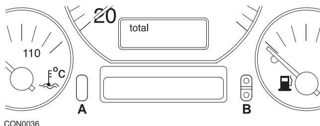
1. Pour réinitialiser le code SRI, mettez le contact d'allumage sur ON. Maintenez enfoncé le bouton du compteur kilométrique A. En maintenant le bouton A enfoncé, mettez le contact d'allumage sur OFF.
