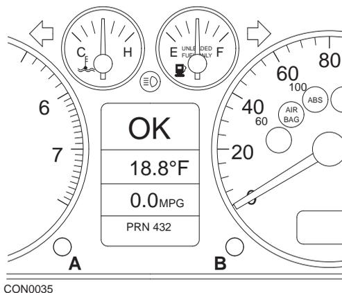
1. Mettez le contact d'allumage sur OFF, puis maintenez le bouton A enfoncé tout en tournant la clé de contact sur ON.
