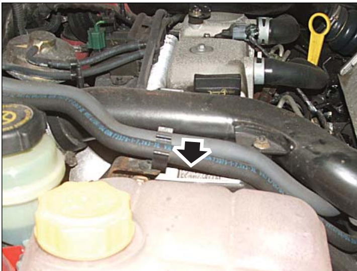
Moteur 1,8 TDCi - Étiquette de l'injecteur indiquée par une flèche sur l'illustration - Vue latérale
