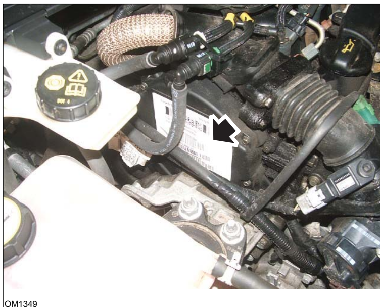
Moteur 1,6 TDCi - Étiquette de l'injecteur indiquée par une flèche sur l'illustration
